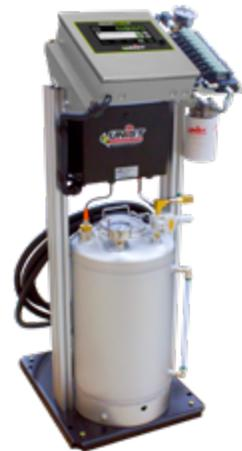
**El sistema de suministro de relleno automático** incorpora un tanque de presión de acero inoxidable con clasificación ASME de 38 litros [10 galones] con regulador de precisión de 0-4 bar [0-60 psi] e interruptores integrales de nivel alto y bajo. El sistema también incluye controles PLC y una bomba eléctrica para rellenar el tanque automáticamente, lo que elimina el tiempo de inactividad. Este sistema proporciona un rendimiento superior cuando extrae fluido de un contenedor o tambor.
