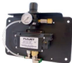
La **bomba de diafragma operada con aire** está disponible para suministrar fluido presurizado desde un contenedor o tambor. La bomba incluye una válvula de encendido/apagado, un regulador de 0-4 bar [0-60 psi] y un bucle de derivación para evitar el estancamiento.
