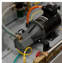
Bomba de concentrado de desplazamiento positivo confiable y preciso
